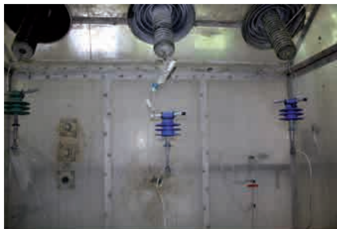
Teste de defeito artificial: montagem dos isoladores inteligentes na câmara de névoa salina
